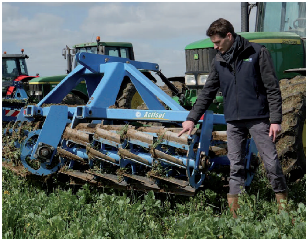
DESTRUCTION D'UN COUVERT (SEIGLE, FÉVEROLE, VESCE) AVEC UN ROULEAU HACHEUR
